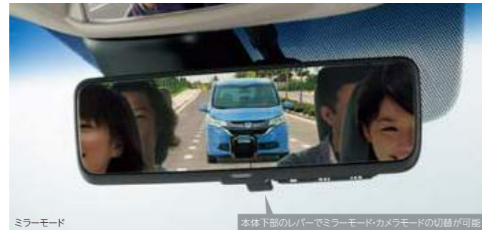
ミラーモード 本体下部のレバーでミラーモード-カメラモードの切替が可能
